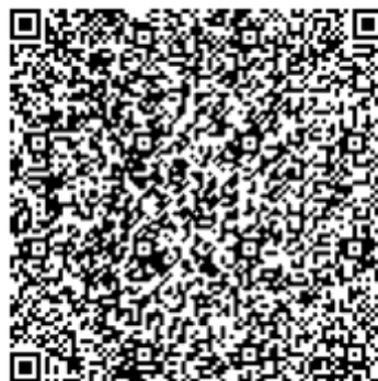
Figura 1 - Exemplo de código QR [47,096mm] e [452 caracteres] (Size=2, ECC=M, Margin= 2 (0,25cm), Module[versão]=17 -> 85x85)
